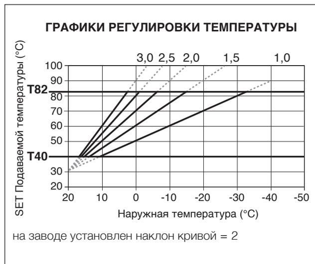
На одной и той же кривой терморегулирования и для той же самой наружной температуры, в случае необходимости, можно изменять заданную температуру котла с помощью переключателя функций (1).
