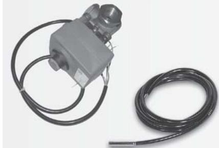
**НАЗНАЧЕНИЕ:** Предназначен для подключения низкотемпературного контура к единичному котлу или гидравлическому разъединителю. Клапан рассчитан на максимальную производительность 18 м<sup>3</sup>/ч. Для полноценной работы в низкотемпературном контуре должен быть установлен циркуляционный насос (заказывается отдельно).
